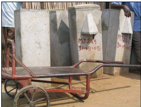
Transportando el filtro con una carretilla especialmente construida.
