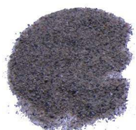
Arena de filtración \leq 0.7 mm (0.03")
