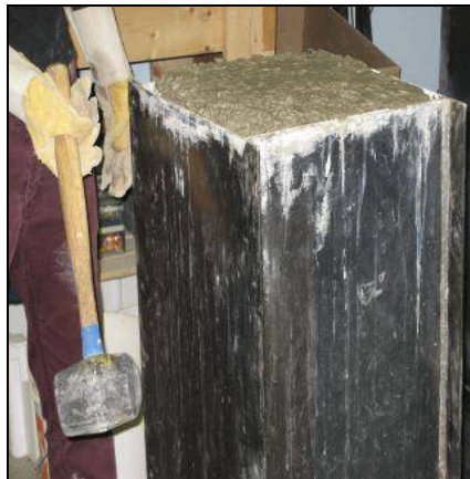
Paso 8 - Haga vibrar el molde con un mazo de caucho para ayudar a sacar el aire del concreto.
