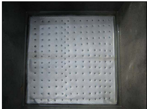
Ejemplo de un mal difusor. Tiene demasiados orificios; sólo se necesita tener 100.
