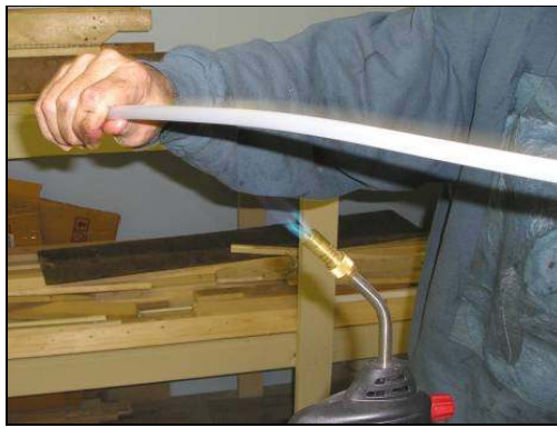
Si el tubo de polietileno está duro, es posible que necesite calentarlo para poder doblarlo.
