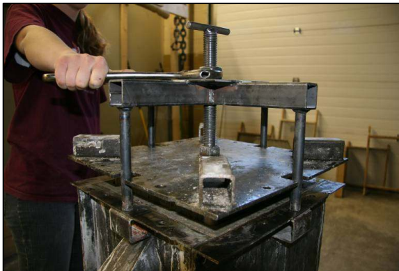
Paso 8 – Ajuste la tuerca del extractor para retirar el molde interior.
