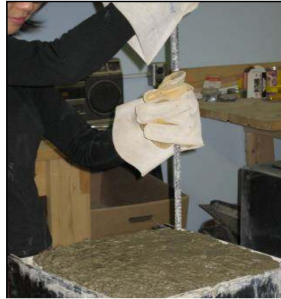
Paso 8 - Use una varilla de metal para ayudar a que el aire salga del concreto.
